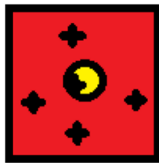
Afbeelding 2.2: Voorbeeld van een bemonsteringsplek van 10x10 meter. Het gele rondje in het midden is het geselecteerde meetpunt (GPS) en de 5 kruisjes zijn de locaties van de schepjes voor het mengmonster.
