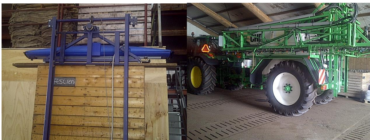
Figuur 4.2 Yara N-Sensor (links, passief licht model, met constructie voor koppeling aan machinedrager voorop de tractor), en CHD veldspuit (rechts).
