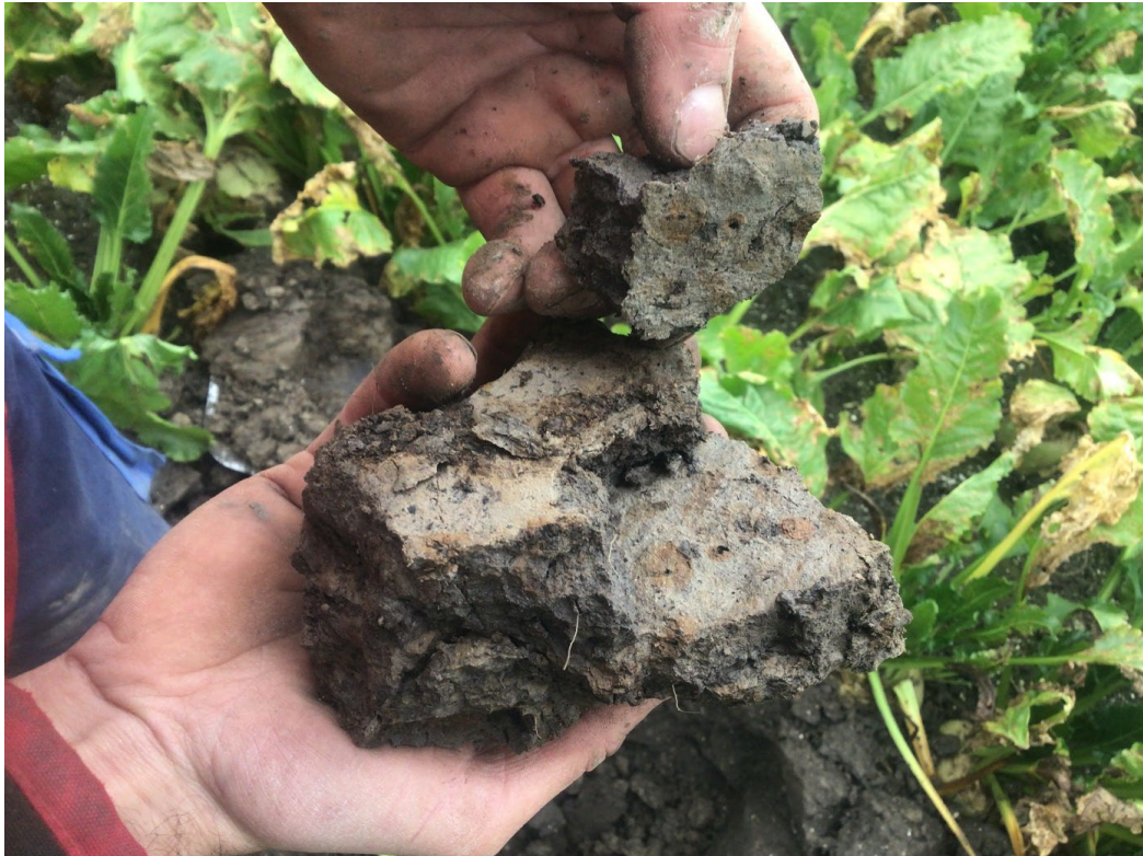
Figuur 26. Gelaagde en poreuze ondergrond met duidelijke roestverschijnselen rondom wortelgangen.
