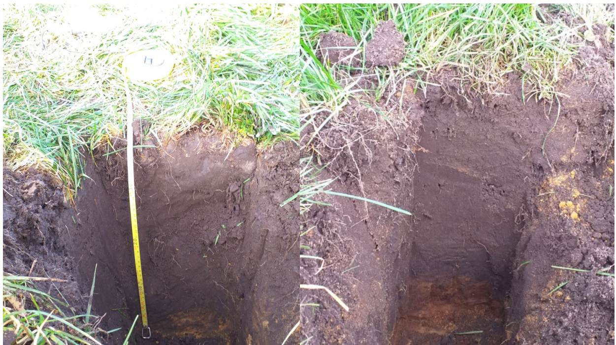
Figuur 4.7 Bodemprofielen grasland met links bodemprofiel met zware klei toevoeging en rechts bodemprofiel zonder klei toevoeging.
