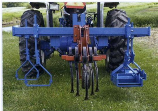
Figuur 8: Stijgbeugelcultivator ( stirrup cultivator ) (links), conventionele triltandcultivator (midden) en blokcultivator ( block cultivator ) (rechts) (Evans et al. , 2012).
