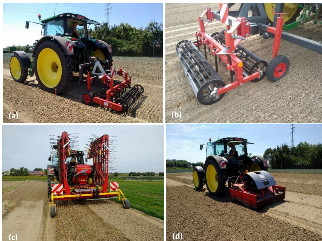
Figuur 20: Werktuigen ingezet tijdens de vals zaaibed operaties. (a/b) Volleldsrolschoffel (breedte = 1.5 m). (c) Treffler wiedeeg met gereduceerde werkbreedte (1.5 m). (d) Vollelds stootbrander (breedte = 1.5 m).
