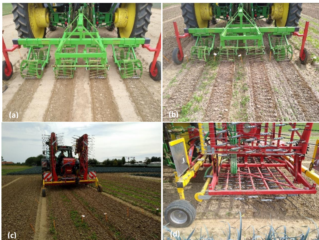
Figuur 26: Werktuigen ingezet tijdens de vals zaaibed operaties. (a/b) Strokenrolschoffel met vier rolschoffelelementen (breedte = 30 cm) v.l.n.r. ingesteld op een bewerkingsdiepte van resp. 1, 2, 3 en 4 cm. (c/d) Treffler wiedeg (breedte = 3 m) ingesteld op een bewerkingsdiepte van 1-1.5 cm.
