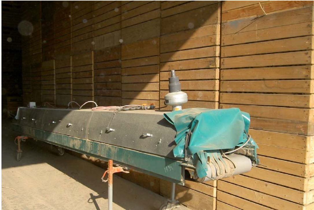
Foto 1. Een transportband met kap om aardappelknollen tijdens de behandeling 15 seconden in contact te brengen met een hoge concentratie ozon.
