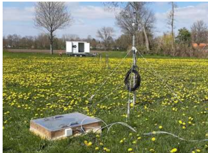
Eddy covariance opstelling voor het meten van de N 2 O gasflux over een groot oppervlak.
