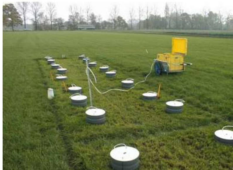
Experimentele opzet voor het uitvoeren van N 2 O metingen. Via slangen wordt het gas uit de kamers naar de gas-analyzer gevoerd.
